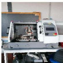
Macchina per taglio metallografico, motorizzata su 3 assi, automatizzata e programmabile.
