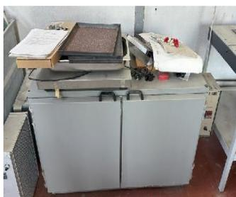
Attrezzatura utilizzata per riscaldare materiali ed eliminare residui di acqua, solventi o altro materiale come, per esempio, carbonati dai campioni da analizzare.
