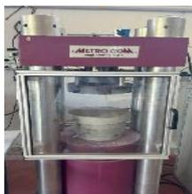
L'apparecchiatura è una pressa idraulica per valutare la resistenza a compressione di provini.
