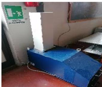
Attrezzatura utilizzata per la riduzione grossolana e preliminare su scala di materiali di media durezza, duri, difficili e fragili.
