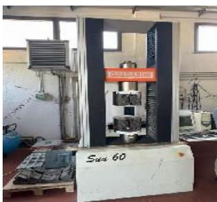
Macchinario utilizzato per prove di trazione e compressione, capacità massima 600kN.
