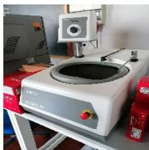
È un sistema automatico di preparazione delle sezioni sottili.
