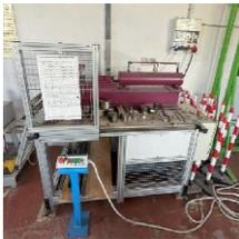
La macchina piegaferri svolge la funzione di piegatura di barre di acciaio al fine di realizzare staffe e sagomati per il cemento armato.
