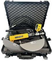
Sistema oleodinamico per prove con martinetti piatti su strutture in muratura.
