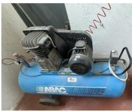
Attrezzatura usata per la produzione di aria compressa per l'attivazione di ulteriori attrezzature pneumatiche o impianti.
