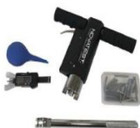
È uno strumento utilizzato per effettuare controlli non distruttivi in situ. È in grado di misurare la resistenza alla compressione delle malte e dei materiali da costruzione di edifici nuovi ed esistenti.
