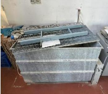
Questa vasca in acciaio inox viene utilizzata per le prove di stagionatura dei provini o dei campioni in condizioni volte ad accelerare lo sviluppo della resistenza. È una vasca progettata per la stagionatura ad acqua calda o vapore.
